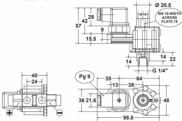
Abb. 2. Abmessungen (mm)
