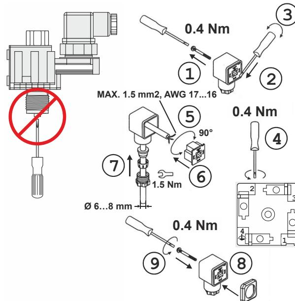
Abb. 4. Anschluß Steckverbinder
