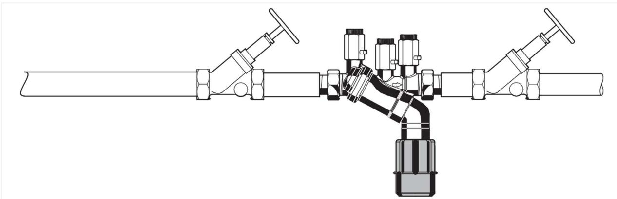
Fig. 1 Exemple d'installation standard pour le dispositif antirefoulement
