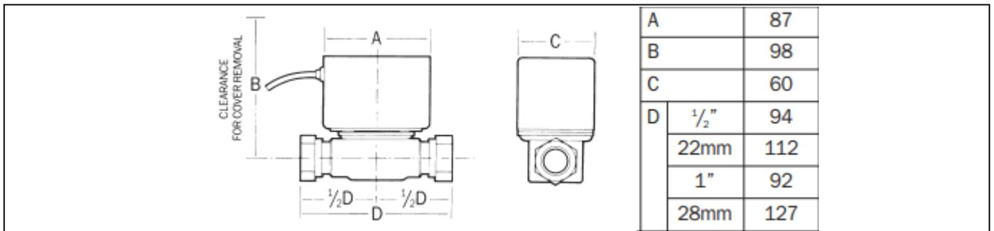
Fig 1 - Dimensions en mm
